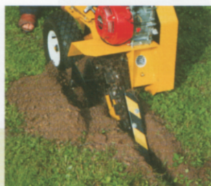
IV° La velocità di scavo varia da 1 a 2 metri al minuto
