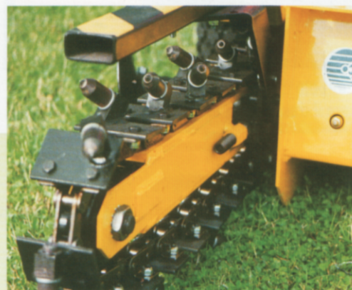
La catena della TR-12 è formata da 18 punte al carbonio. La loro disposizione irregolare permette di asportare durante lo scavo sassi di diverse dimensioni.
