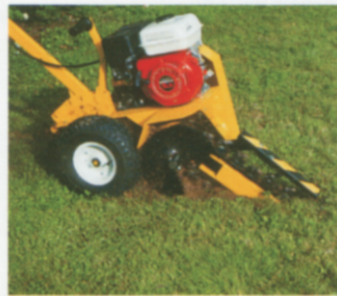
II° Le ruote sono bloccate e impediscono alla TR-12 di trascinarsi in avanti.
