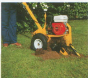
III° La coclea spinge di lato la terra asportata.
